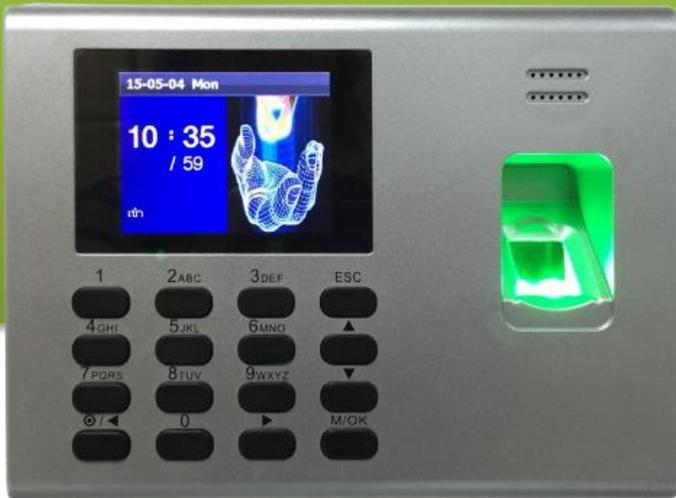
El dispositivo K40 es una elegante e innovadora terminal biométrica IP diseñada para gestionar la asistencia de empleados y controlar el acceso de una puerta.
